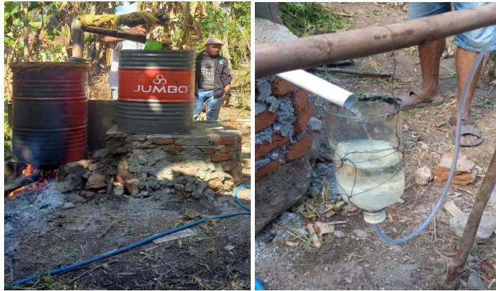
Gambar 6. Ketel penyulingan minyak M. cajuputi
