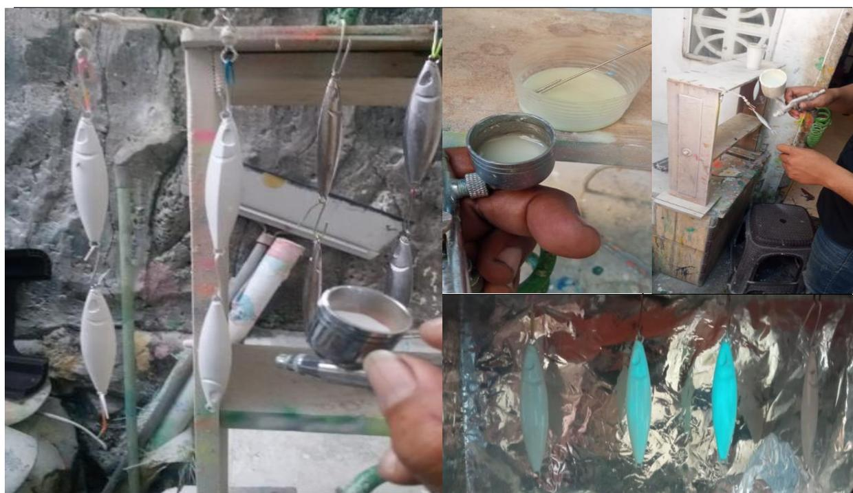
Gambar 2. Pelapisan fosfor dengan teknik vakum pada umpan buatan tercetak berbahan dasar timah
