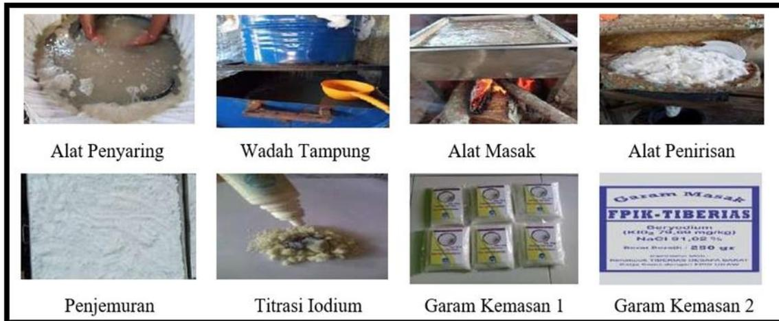
Gambar 3. Alur produksi garam masak hingga pengemasan
